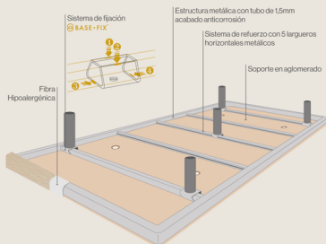
Vista invertida de la estructura de la tapibase en medidas de 135 a 160cm.
